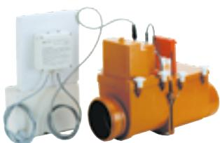
**Тип 3:** Възвратна клапа за използване в хоризонтални канализационни клонове, с един автоматичен затвор, задействан с външна енергия (електрическа, пневматична или друга) и един ръчен авариен затвор, който е независим от автоматичния затвор.
